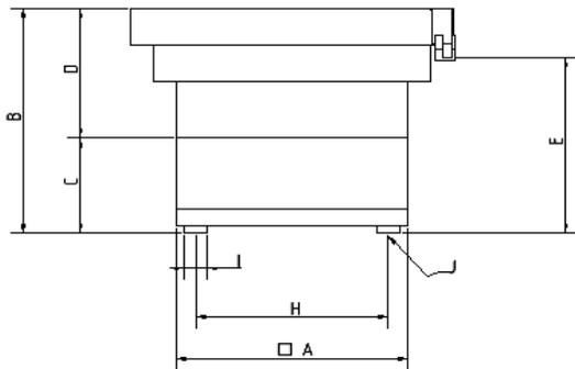
Zuführgeräte mit Stufentopf gewährleisten freien Teiletransport ohne Verklemmungsrisiko vom Boden des Topfes bis zum Auslauf
